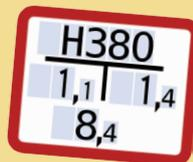
Damit die Feuerwehr den Unterflurhydrant leicht finden kann, ist bei jedem Unterflurhydrant ein Hinweisschild angebracht. Die obere Zahl gibt an, wie dick in Millimeter die Rohrleitung des Hydranten ist.
