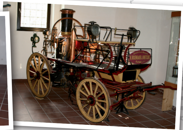
Dampfheuerspritze für Pferdezug (Baujahr 1908)
